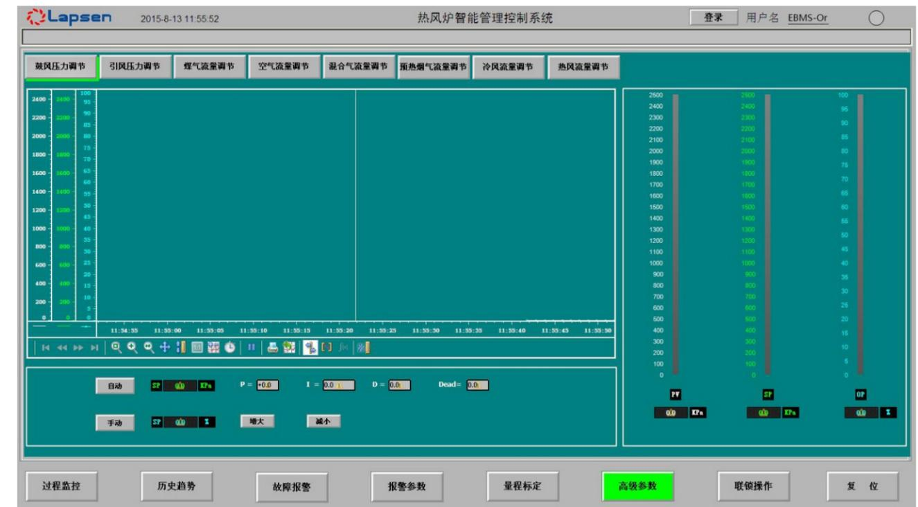
首次开机运行或者长时间关机后开机运行需要对热风炉智能管理系统的参数进行设置。特别是报警点设置，它们直接影响着系统的安全可靠的运行；在系统运行过程中，为了配合设备检修和故障处理的情况下，必要时需要对控制系统回路进行旁路设定，解除连锁控制关系；上图显示高级参数设置画面，有不同权限的用户供工程师和操作员分别登陆，便于工程师站进行各工艺参数的PID数值设置；
